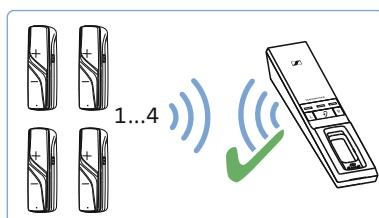
С передатчиком можно одновременно использовать до 4 сопряженных приемников. Все остальные сопряженные и включенные приемники не смогут подключиться к передатчику.
