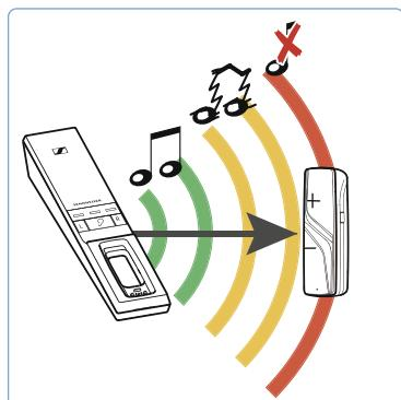
Радиус действия передатчика зависит от условий окружающей среды, например толщины и материала стен. Если вы с приемником будете выходить за пределы радиуса действия передатчика, сначала звук будет прерываться на некоторое время, а потом вообще пропадет. Вы услышите предупреждающие сигналы из приемника, индикатор *Статус приемника* будет мигать зеленым (или красным, если аккумулятор почти разряжен).
