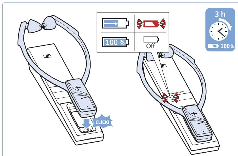
Для сохранения оптимального уровня заряда рекомендуется постоянно хранить наушники в зарядном отсеке передатчика. Автоматическая система зарядки предотвращает перезарядку аккумулятора, и время работы всегда будет максимальным.
