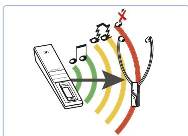
Радиус действия передатчика зависит от условий окружающей среды, например толщины и материала стен. Если вы с наушниками будете выходить за пределы радиуса действия передатчика, сначала звук будет прерываться на некоторое время, а потом вообще пропадет. Индикатор *Статус наушников* на наушниках будет мигать зеленым (или красным, если аккумулятор почти разряжен). После отключения наушников передатчик автоматически выключится (перейдет в режим ожидания). Индикатор *Статус передатчика* погаснет.
