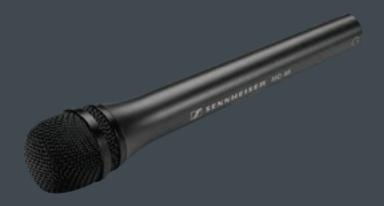
MD 46 - высококачественный динамический микрофон с кардиоидной характеристикой направленности. Разработан для внестудийной работы, записи репортажей для радио и телевидения. Благодаря тщательно подобранному сочетанию размера (длинный корпус) и веса микрофон удобно держать в руке. Специальная конструкция капсюля и двухслойная защитная сетка надёжно защищают микрофон от контактных шумов (хлопков и ударов) и шумов окружающей среды (шума ветра, задувания).
