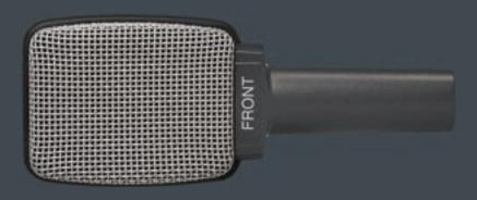
Динамический микрофон для записи и озвучивания гитарных кабинетов и комбиков с близкого расстояния. Благодаря плоской форме корпуса оптимально позиционируется по отношению к источнику звука. Мощный «рык» гитарных усилителей этот микрофон передает очень естественно, так как не боится экстремальных уровней громкости (до 160 дБ).
