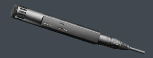
МКН 40 применяется как основной микрофон для записи речи или групп инструментов, особенно в акустически не вполне корректных помещениях (с повышенной реверберацией). Имеет кардиоидную характеристику направленности и высокий коэффициент подавления звуков вне оси направленности. Обеспечивает нейтральное сбалансированное звучание. Имеет переключаемый фильтр НЧ (для использования на расстоянии примерно 0,5 м от источника звука) и переключаемый аттенюатор -10 дБ.
