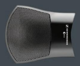
Конденсаторный микрофон с предварительной поляризацией капсюля (электретный). Акустические свойства микрофона оптимизированы для работы с речью, вокалом и музыкальными инструментами. е 912 предназначен для установки на плоских поверхностях: столах («круглый стол», конференция), лекторских трибунах, кафедрах, в корпусе фортепьяно, а также на сценах оперных и драматических театров. Микрофон выпускается в двух вариантах отделки корпуса.
