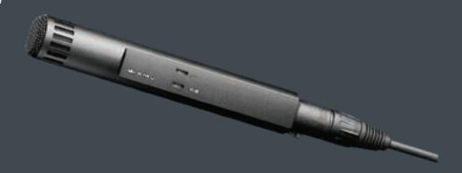
Суперкардиоидный микрофон МКН 50 применяется для озвучивания солирующих инструментов и как точечный микрофон в тех случаях, где требуется высокая степень подавления звуков вне оси направленности. Имеет переключаемый фильтр НЧ (для использования на расстоянии примерно 0,5 м от источника звука) и переключаемый аттенюатор -10 дБ.
