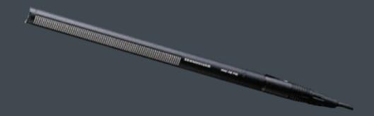
Микрофон типа «пушка» построен по принципу интерференционной трубы, что обеспечивает превосходную направленность при небольших размерах. МКН 416 имеет высокую степень подавления обратной связи и отличную разборчивость при передаче согласных звуков. Всё это делает его универсальным микрофоном для внестудийного кино-, видеопроизводства, радио- и телевещания.
