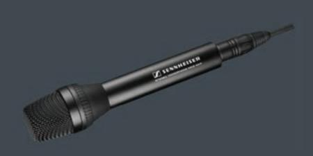
МКЕ 44 Р представляет собой высококачественный конденсаторный электретный стерео микрофон с двумя кардиоидными микрофонными капсюлями, установленными относительно друг друга под углом 90°. Эта конструкция позволяет получить качественный стереозвук при записи методом XY.
